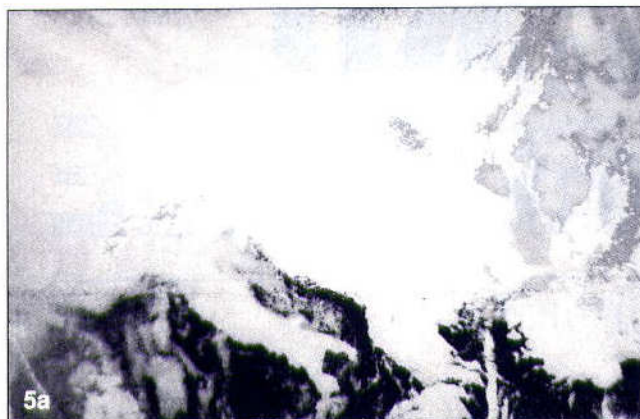
⑤ Un altro esempio di manipolazione di immagine che si commenta da sola. In figura 5a è riprodotta una telefoto così come viene ricevuta mentre in 5b la stessa è stata sottoposta ad equalizzazione dell'istogramma. Immagine trasmessa dal satellite NOAA nel canale del vicino IR (800nanomt).
