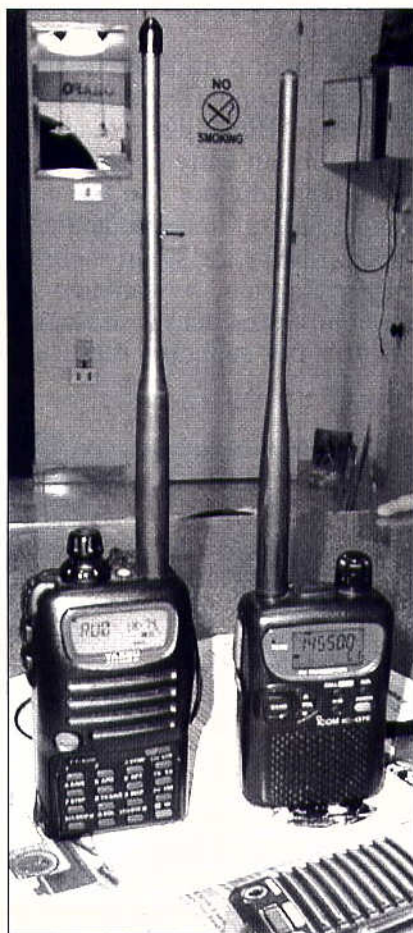
FT50R e IC-Q7 con antenne ridotte autocostruite
