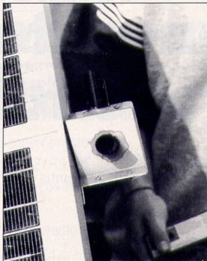
Foto 2 - particolare del sensore di luce
