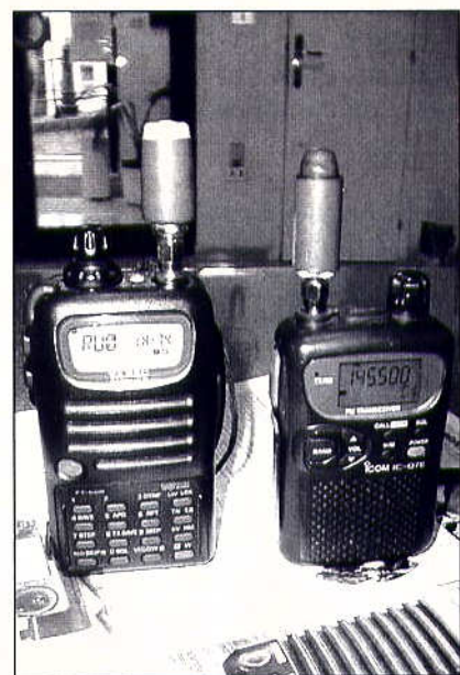
FT50R e IC-Q7 con antenne ridotte autocostruite
