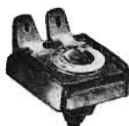
Fig. 10 - Compensatore di tipo a pressione. Le variazioni capacitive si raggiungono intervenendo con un cacciavite sulla testa della piccola vite centrale.
