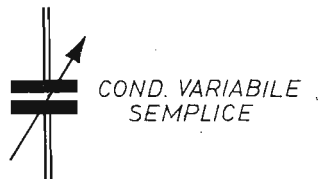
Fig. 5 - Simbolo elettrico di condensatore variabile ad una sola sezione.
