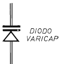
Fig. 9 - Simbolo elettrico di un diodo varicap.
