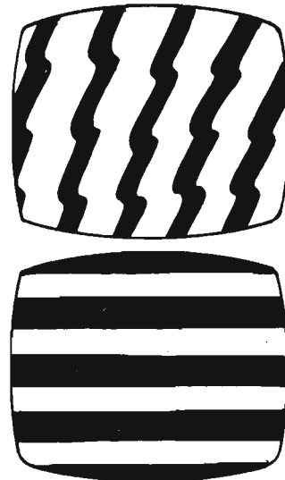
Fig. 1 - Con il generatore di barre, presentato e descritto in queste pagine, si possono far comparire, sullo schermo di ogni cinescopio, delle barre bianche e nere, orizzontali o verticali, oppure trasversali più o meno contorte.
