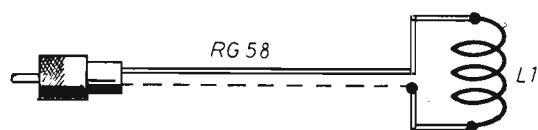
Fig. 4 - Schema teorico del primo tipo di sonda captatrice di segnali a radio-frequenza.
