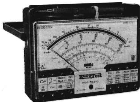
Fig. 3 - Esempio di tester di tipo analogico con alimentazione a pile.
