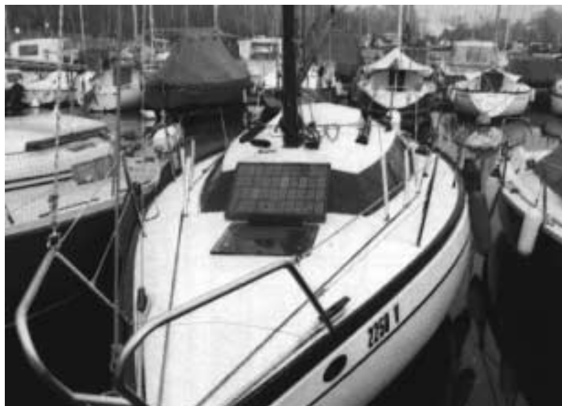
A sinistra, un impianto fotovoltaico utilizzato per alimentare un lampeggiante di emergenza. Sopra, dei pannelli solari provvedono alla ricarica della batteria di una imbarcazione.
