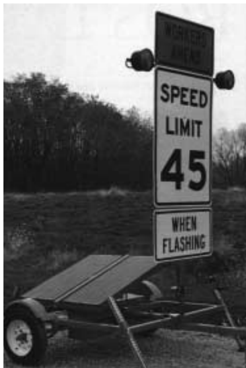
A sinistra, un impianto fotovoltaico utilizzato per alimentare un lampeggiante di emergenza. Sopra, dei pannelli solari provvedono alla ricarica della batteria di una imbarcazione.
