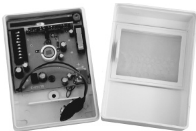
Completo di trasmettitore a radio frequenza del segnale di allarme
