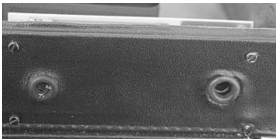
La piastra con la telecamera ed il microfono va fissata con dei distanziatori al bordo interno della valigetta. In prossimità dei due sensori è necessario realizzare dei fori di diametro adeguato per consentire agli stessi di catturare correttamente le immagini ed i suoni.
