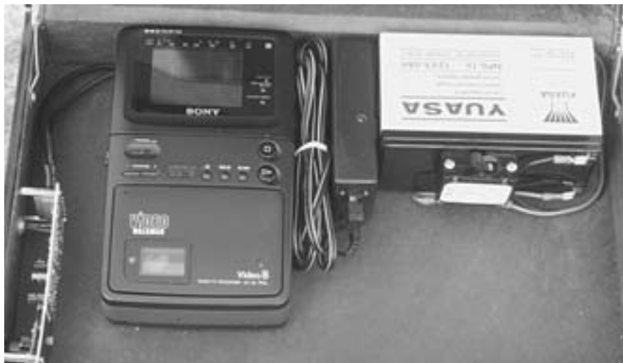
La sequenza fotografica evidenzia come sono stati montati i vari elementi all'interno della valigetta. Nel nostro caso abbiamo utilizzato un videoregistratore con alimentazione in corrente continua ma, ricorrendo ad un inverter PWM, è anche possibile impiegare un normale videoregistratore con alimentazione a 220 volt.
