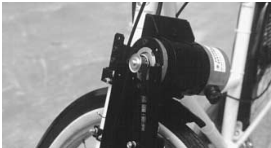
Il motore viene alimentato mediante delle batterie ricaricabili al piombo montate all'interno di un apposito vano portaoggetti fissato sul portapacchi posteriore. A seconda del modello utilizzato, l'accumulatore garantisce un'autonomia compresa tra 20 e 30 chilometri.
