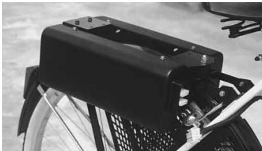
Il motore viene alimentato mediante delle batterie ricaricabili al piombo montate all'interno di un apposito vano portaoggetti fissato sul portapacchi posteriore. A seconda del modello utilizzato, l'accumulatore garantisce un'autonomia compresa tra 20 e 30 chilometri.
