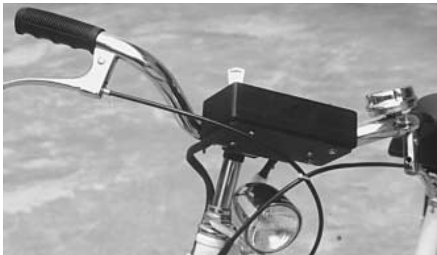
Le immagini evidenziano le modifiche apportate alla bicicletta. In alto, la centralina di controllo alloggiata in un contenitore plastico a tenuta stagna fissato al centro del manubrio; in basso il motore DC da 120 watt con la relativa cinghia di trasmissione.
