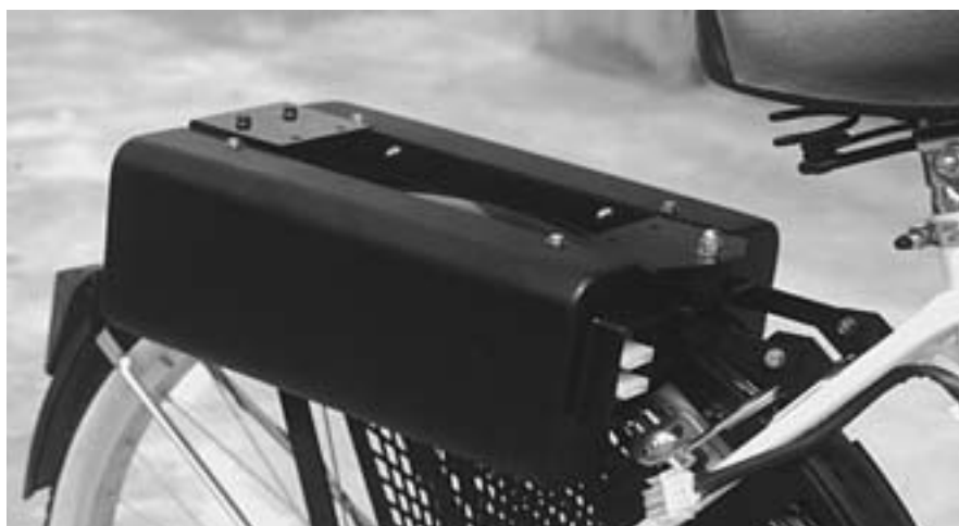
Il pacco batterie può essere alloggiato sul cestello porta oggetti posteriore (sopra) oppure sotto i pedali facendo uso di un apposito alloggiamento (sotto).
