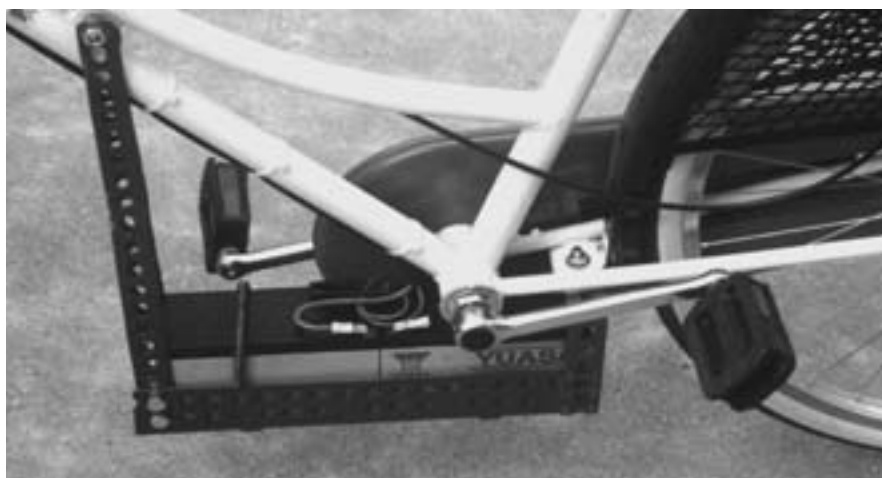
Il pacco batterie può essere alloggiato sul cestello porta oggetti posteriore (sopra) oppure sotto i pedali facendo uso di un apposito alloggiamento (sotto).
