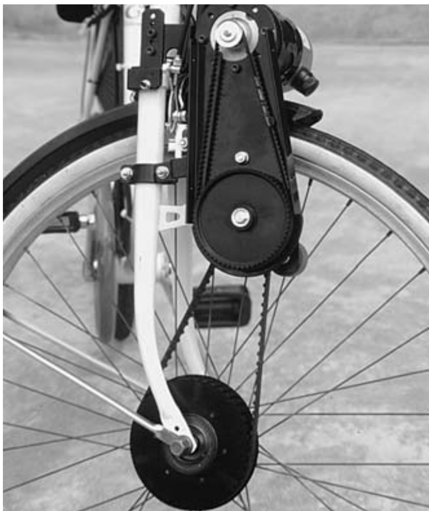
Sopra, particolare del motore DC da 120 watt e della relativa staffa di fissaggio alla forcella anteriore. Sotto, il gruppo motore e trasmissione al termine del montaggio.
