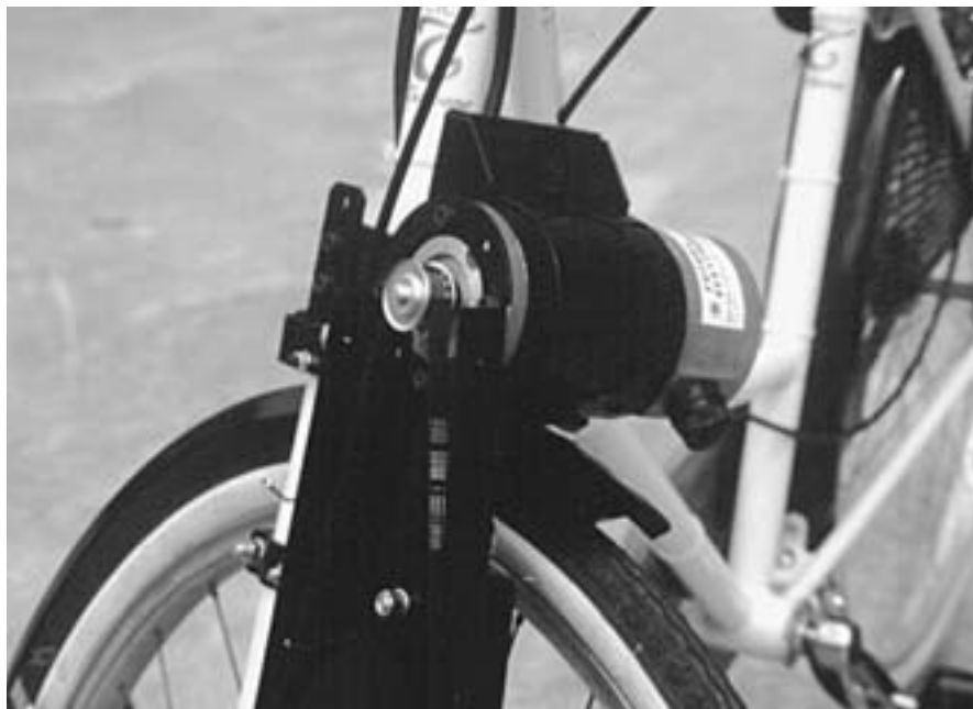
Sopra, particolare del motore DC da 120 watt e della relativa staffa di fissaggio alla forcella anteriore. Sotto, il gruppo motore e trasmissione al termine del montaggio.
