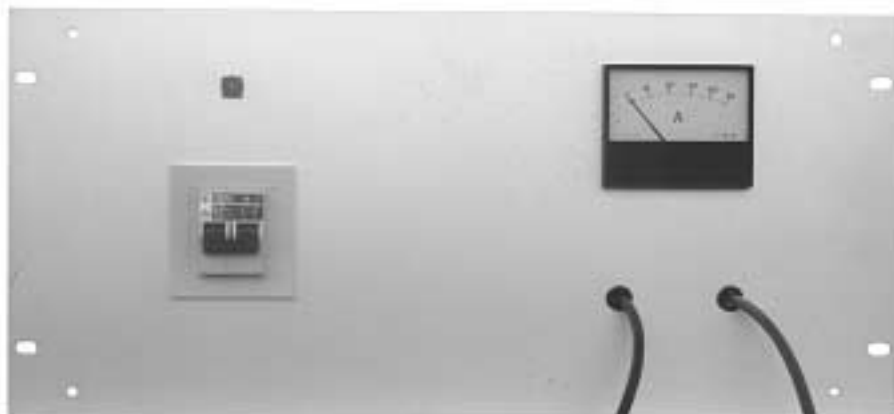
In alto, traccia rame in dimensioni reali della basetta utilizzata per montare l'alimentatore e (sotto) il pannello frontale del prototipo da noi realizzato. L'intera apparecchiatura è stata alloggiata all'interno di un contenitore metallico della Ganzlerli.
