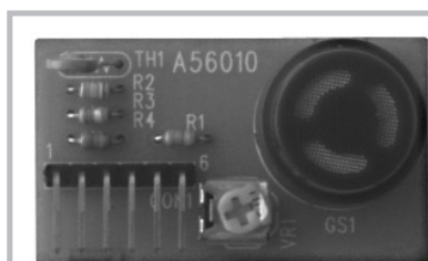
Il modulo pretarato della FIS con a "bordo" il sensore di gas metano ad ossido-riduzione.
