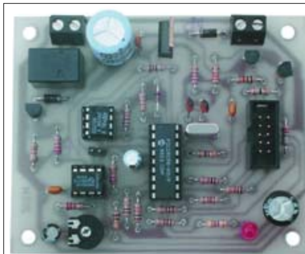
Il prototipo della serratura elettronica con chipcard al termine del montaggio. Si noti l'estrema semplicità del circuito che implementa soltanto tre circuiti integrati: un microcontrollore PIC, una memoria EEPROM e un timer 555.
