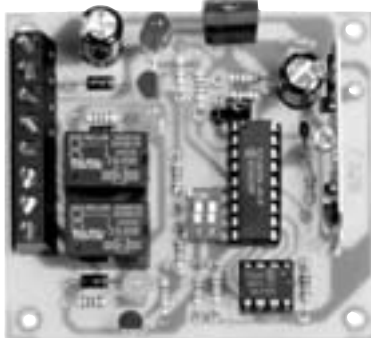
Il nostro ricevitore è realizzato con due soli circuiti integrati: un microcontrollore PIC 16C54 e una piccola memoria seriale.
