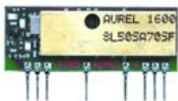
Per trasmettere e ricevere i comandi del brandeggio vengono utilizzati moduli ibridi funzionanti a 868 MHz.
