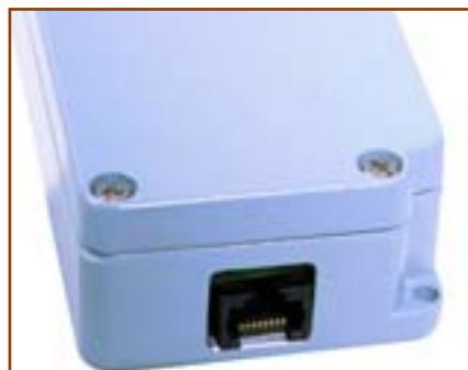
Il contenitore metallico all'interno del quale è stata alloggiata l'unità remota dispone da un lato di due fessure per il passaggio dei cavi di antenna e dall'altro di una cava in corrispondenza del connettore RJ-45.
