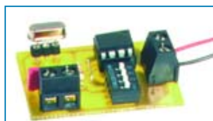
Questo semplice circuito permette di generare frequenze non standard, partendo da quarzi di valore facilmente reperibile in commercio.
