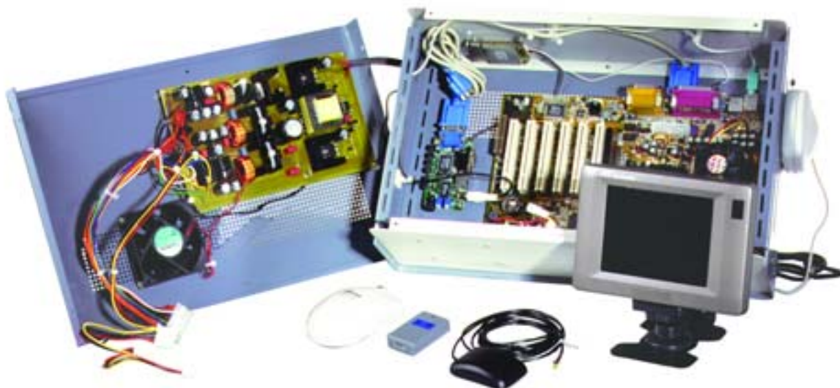
Foto di insieme del Personal Computer da auto da noi realizzato. Vediamo l'alimentatore ATX, il case contenente la scheda madre, il ricevitore GPS, il convertitore VGA/PAL e il ricevitore che consente l'accensione del PC tramite telecomando. Come accessori esterni troviamo il display LCD, l'antenna GPS, il telecomando di accensione ed il mouse radiocontrollato.
