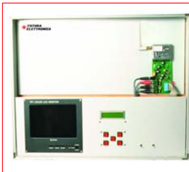
Sul coperchio della valigetta abbiamo montato il monitor ad incasso e lo scanner audio/video a 2,4 GHz con i relativi controlli.
