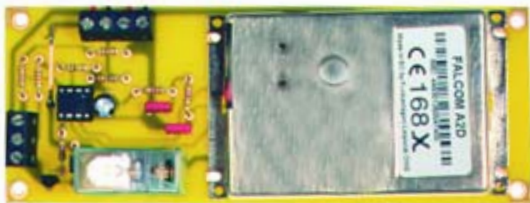
Il prototipo del combinatore GSM a montaggio ultimato.
