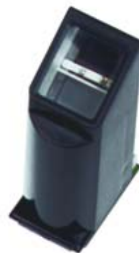
Scanner ottico Polaroid appositamente realizzato per l'acquisizione di impronte digitali.
