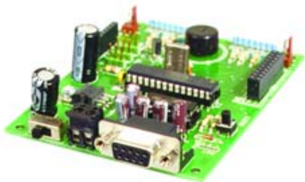
Una bella immagine della Motherboard a montaggio ultimato. In primo piano il connettore DB9 mediante il quale è possibile trasferire i programmi dal PC al microcontrollore montato sulla scheda.
