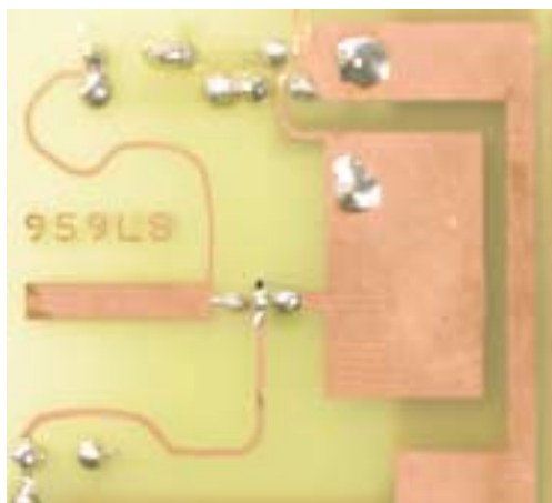
Le piste attorno al transistor costituiscono induttanze e capacità necessarie all'oscillatore.
