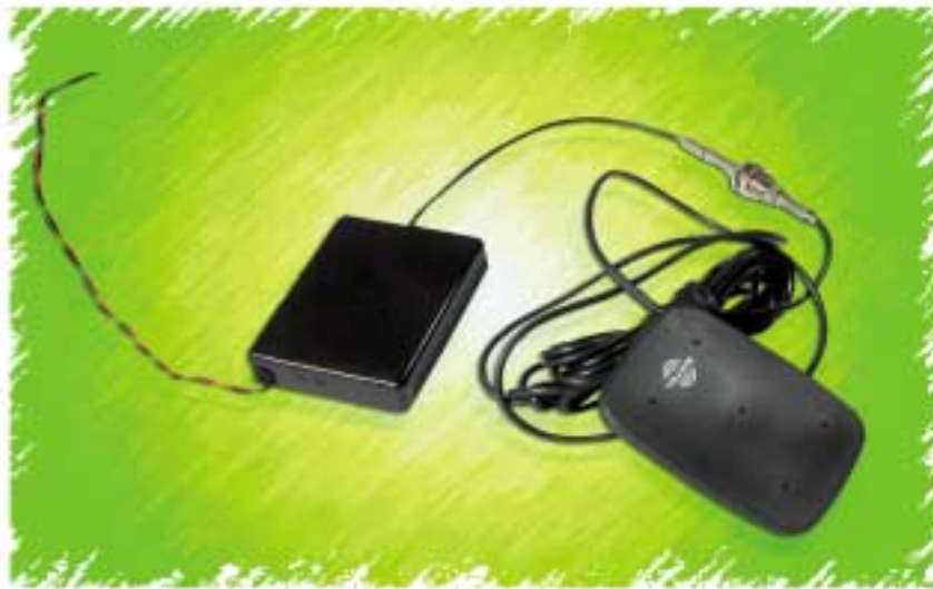
Una visione d'insieme del nostro sistema di ascolto ambientale. Tutti i componenti trovano posto in un contenitore di dimensioni particolarmente contenute; gli unici elementi esterni sono l'antenna GSM ed i due microfoni miniatura.
