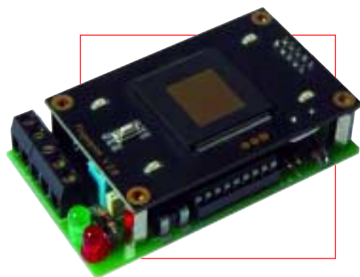
Il dispositivo per il riconoscimento e la gestione delle impronte digitali da noi messo a punto utilizza un sensore MBF200 della Fujitsu.
