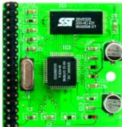
Quale sistema di riconoscimento vocale abbiamo utilizzato un modulo Voice Extreme del quale ci siamo occupati in passato con un apposito Corso.
