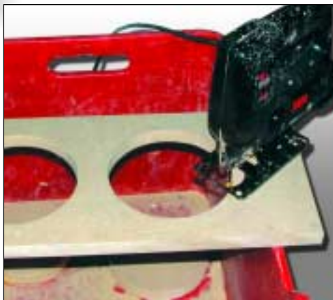
La sequenza per il taglio delle sedi per gli altoparlanti nonché la finitura con carta abrasiva.
