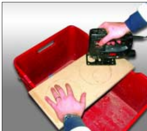
La sequenza per il taglio delle sedi per gli altoparlanti nonché la finitura con carta abrasiva.
