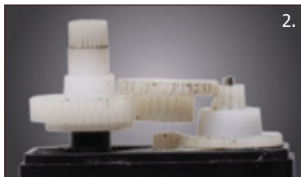
Fig. 2: Gli ingranaggi interni del riduttore.
