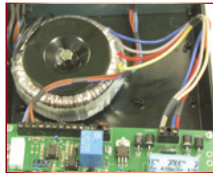
Fig. 3 - Cablaggio del transistor e del trasformatore toroidale.
