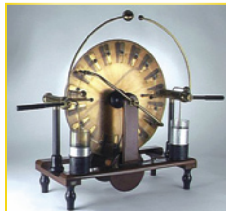
Fig. 3 - Generatore elettrostatico Wimshurst: è costituito da due dischi che ruotano in verso opposto e che si caricano per sfregamento.
