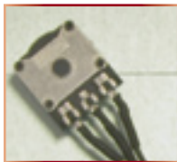
Fig. 1 - Per proteggere i terminali è consigliabile utilizzare del termorestringente.
