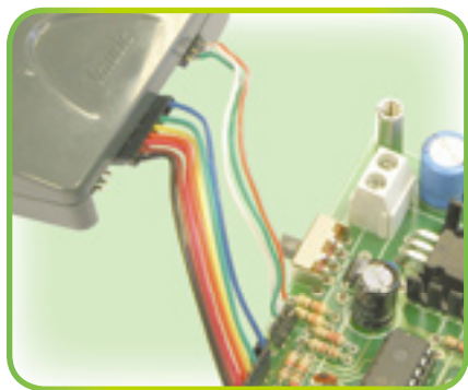
Fig. 2 - Particolare dei collegamenti tra il VMusic2 e la basetta.
