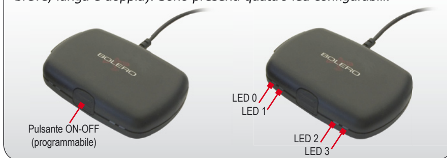
Fig. 12 - L'unico pulsante viene utilizzato sia per l'accensione (pressione di 5 s) che per avviare particolari operazioni (pressione breve, lunga e doppia). Sono presenti quattro led configurabili.
