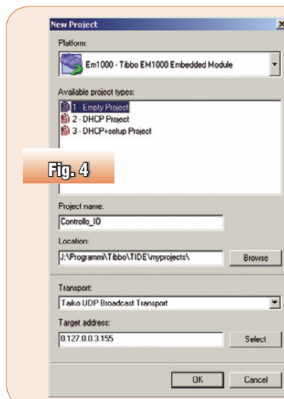
Fig.4 - Schermata iniziale per la creazione di un nuovo progetto con Tibbo IDE.
