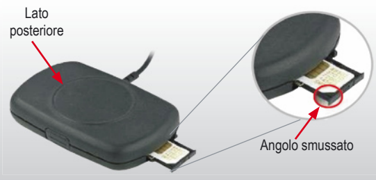
Fig. 14 - Particolare del vano porta SIM, posto sul lato sinistro (rispetto al pannello frontale) del contenitore plastico.
