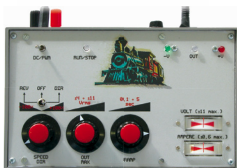
Fig. 2 - Frontalino del prototipo da noi realizzato. I led RUN/STOP e OUT sono bicolore. Gli strumenti a zero centrale utilizzati possono essere sostituiti da analoghi strumenti tradizionali. In tabella 1 sono riportate le funzioni di ciascun controllo.
