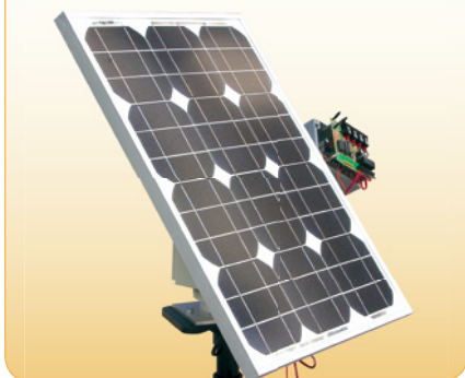
Fig. 7 - Il nostro prototipo è stato realizzato con un pannello da 24 watt massimi (17,4 Vp, 1,38 A massimi).
