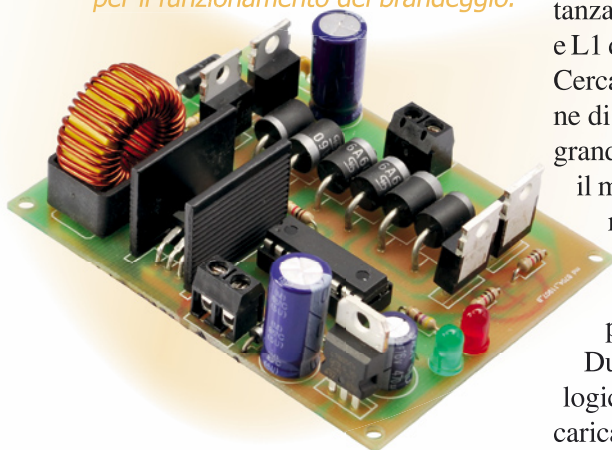
Fig. 4 - Il convertitore DC-AC montato. Trasforma i 12 Vdc provenienti dal regolatore di carica in 24 Vac (a onda quadra) necessari per il funzionamento del brandeggio.
