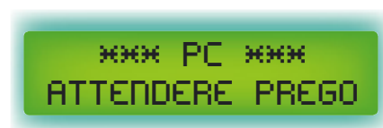
Fig. 1 - Il display segnala quando il cartellino è collegato al PC.
