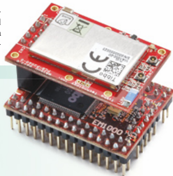
Fig. 2 - Scheda modificata con il modulo EM1000+WA1000
