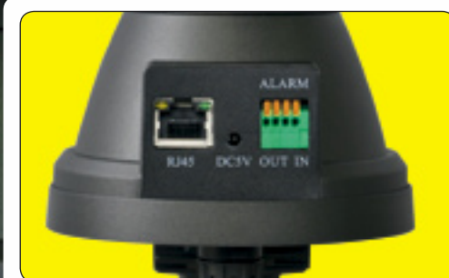
Fig. 1 - La telecamera IP CP360 è disponibile sia con connessione wired che wireless. In entrambi i casi sono presenti anche gli ingressi e le uscite di allarme per impiego locale.
