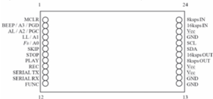
Figura 2. Pinout (vista dall'alto) del modulo registratore vocale SPC01 .
