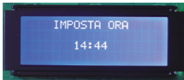
Impostazione dell'orario dell'orologio di sistema: ore e minuti si definiscono con i tasti P7 e P8.
