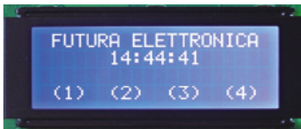
A riposo, con tutti i quattro i canali inattivi, il visualizzatore LCD si presenta come illustrato in questa foto.
