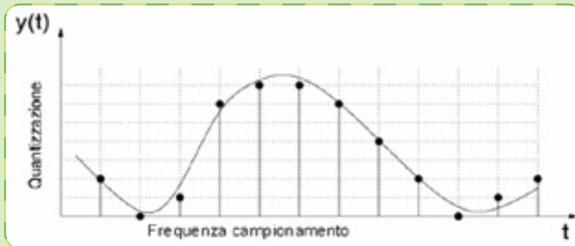
Fig. A - Andamento temporale di un segnale continuo, campionato con una data frequenza f . Ogni campione del segnale viene quantizzato da un convertitore ADC ad elevata precisione.
