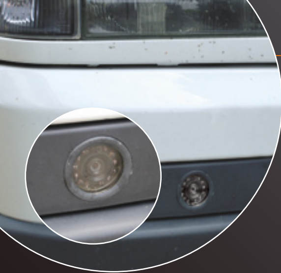
Telecamera nel paraurti anteriore.
