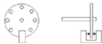
Fig. 1 - Struttura schematica di un encoder ottico.
