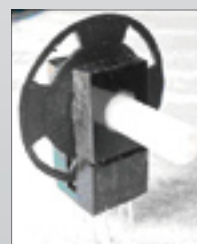
Fig. 4 Encoder ottico a quattro impulsi/giro, autocostruito.
