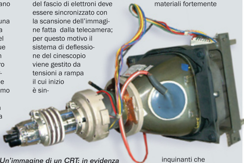
Un'immagine di un CRT: in evidenza il cannone elettronico (a sinistra) le bobine di deflessione (al centro) e lo schermo (a destra).
