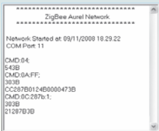
Fig. 4 - Messaggi in transito sulla seriale dopo l'accensione del LED 1 del nodo con indirizzo short 0x287B.
