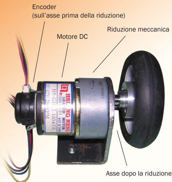
Fig. 4 - Ruota, motoriduttore ed encoder.
