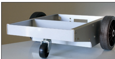
La struttura meccanica spoglia, con montati i motoriduttori per le ruote di trazione ed il motore senza spazzole per le lame.
