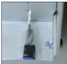
Collocazione delle bobine usate come sensori del recinto sepolto.
