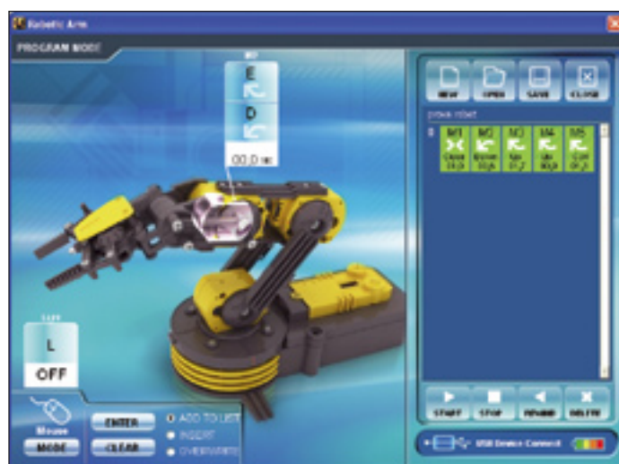
Costruzione delle sequenze di movimenti del braccio.
