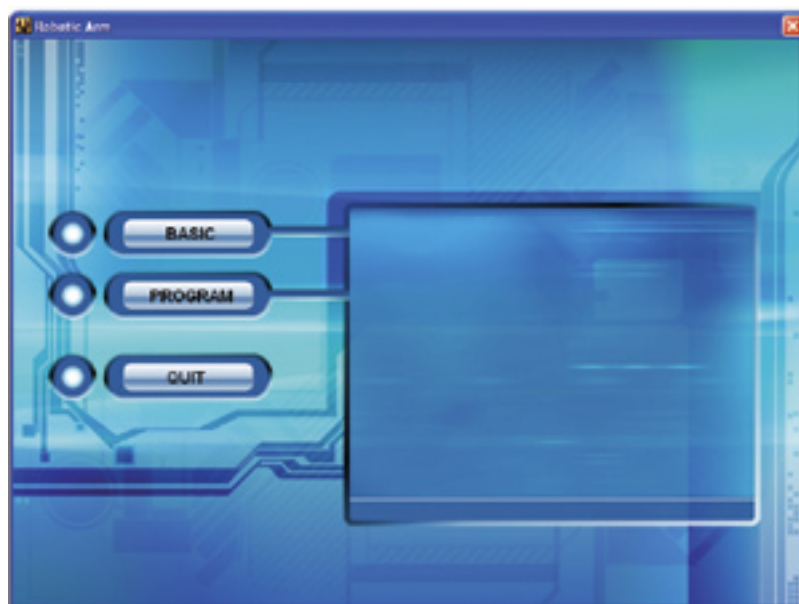
Con BASIC si entra nel comando manuale e con PROGRAM si accede alla creazione delle sequenze di comando.
