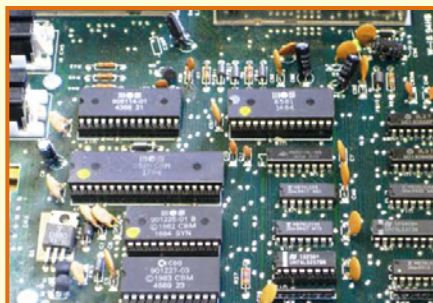
Fig. 2 - Dispositivi FPLA nei primi calcolatori.
