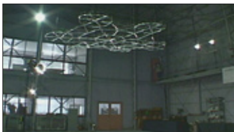
Fig. 8 - Un lifter da 5 metri, realizzato dalla Meisei University in Giappone.
