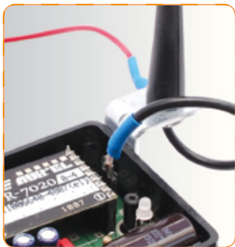
L'antenna da noi usata per l'RX si collega con un cavetto al connettore siglato ANT.
