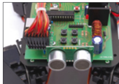
Il circuito di controllo del robot si interfaccia direttamente ad un PC mediante una connessione USB ed è predisposto per ospitare un SONAR.
