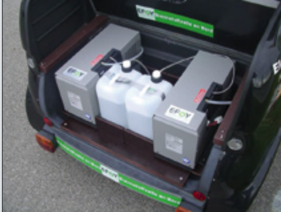
Un'auto realizzata in Germania con un generatore a fuel-cell PEM a metanolo che carica le batterie con cui viene azionato il motore elettrico ( www.efoy.de ).
