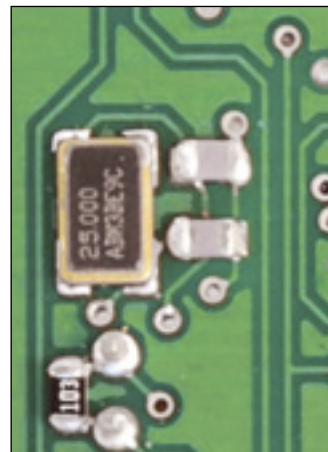
Fig. 5 Vista ravvicinata dei quarzi in formato SMD; si vede chiaramente lo stagno usato sui quattro angoli del componente per fissarlo alle rispettive piazzole.
