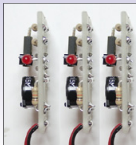
Fig. 4 Assemblaggio di un blocco (stack) di bilanciatori.
