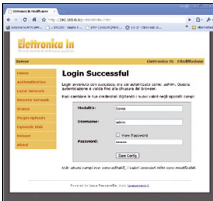
Fig. 4 Pagina Authentication per inserire i nuovi parametri di autenticazione.
