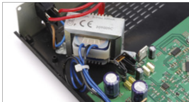
Fig. 19 Particolare del montaggio dell'interfaccia all'interno del contenitore plastico Teko AUS12. A destra si vedono il trasformatore d'alimentazione e l'interruttore generale.
