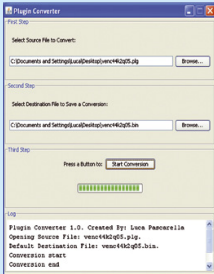
Fig. 11 - Applicazione Java per convertire i plugin forniti dalla VLSI Solution in file binari da caricare nella EEPROM dell'encoder.
