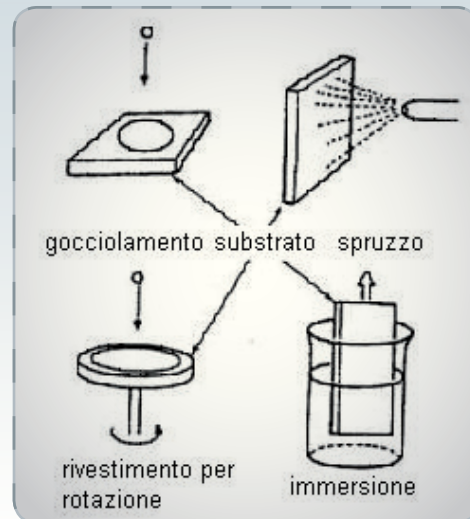
Fig. 5 - Tecniche di rivestimento utilizzate nel metodo sol-gel.
