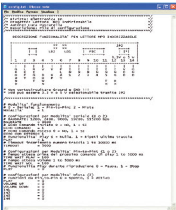
Fig. 5 - Vista del file Config.txt generato automaticamente dal firmware del PIC.
