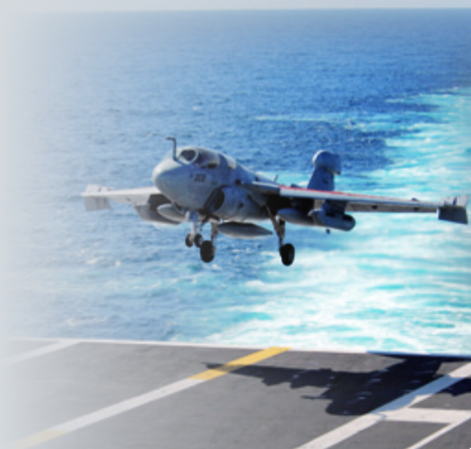
Sistema di atterraggio strumentale basato sui dati ricavati dal GPS a bordo dell'aereo ed opportunamente corretti in tempo reale mediante una semplice infrastruttura aeroportuale denominata GBAS (Ground Based Augmentation System). Un sistema del genere (JPALS) è stato recentemente messo a punto dalla Raytheon anche per l'atterraggio degli aerei militari sulle portaerei USA.
