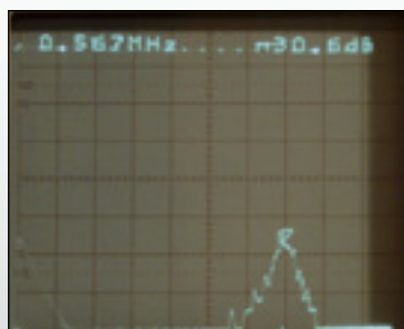
Fig. 5 - Schema di collegamento e risultato sullo schermo della prova della frequenza di risonanza di circuito LC.
