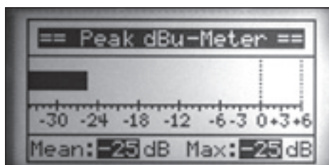
Indicazione dei picchi del segnale in dB: avviene con una barra e numericamente (valore medio e picco).
