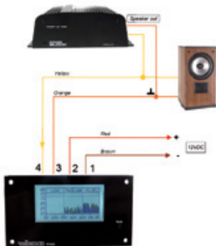
Collegamento dell'analizzatore di spettro alla cassa acustica di un impianto hi-fi tradizionale; i numeri sono quelli dei contatti del connettore CN1.
