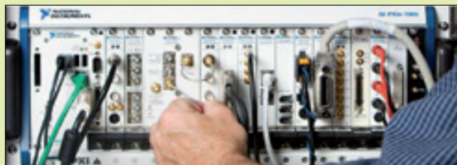
Fig. 6 - LabVIEW è in grado di gestire una grande varietà di bus di comunicazione, dai più economici e commerciali (USB, RS232) fino a quelli proprietari ed altamente professionali (PXI, PXI Express).
