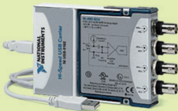
Fig. 2 - Cartuccia con ingressi analogici e carrier USB, NI USB-9162.
