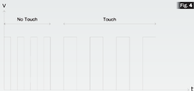
Andamento della frequenza di oscillazione del Capacitive Sensing Module al variare della capacità.
