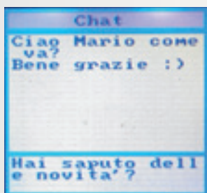
Fig. 11 - Funzionalità di Chat: il frame ha aggiunto una nuova area in basso, nel quale vengono riportati i messaggi ancora da inviare. Lo spazio centrale contiene la cronologia dei messaggi inviati e ricevuti. Con il pulsante return di SW3 si termina la sessione di chat.
