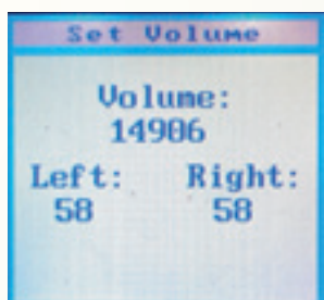
Fig. 15 - Schermata di controllo del livello del volume audio. Funzioni UP e DOWN associate al pulsante SW3.
