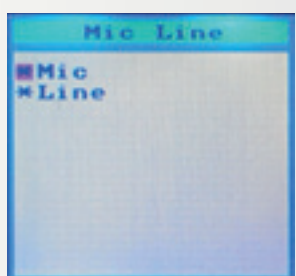
Fig. 17 - Configurazione dell'encoder per ricevere un segnale dall'ingresso audio RCA o dal microfono interno. In corrispondenza della selezione software è importate spostare manualmente lo switch SW2 come mostrato nella Fig. 3.
