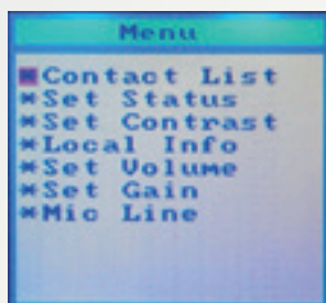
Fig. 5 - Menu principale e sottovoci di menu accessibili tramite il pulsante SW4.
