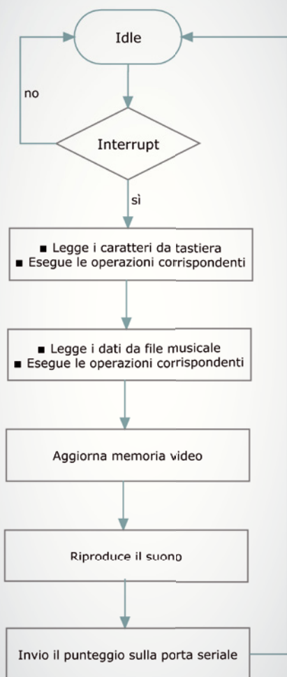
Fig. 2 - Diagramma di flusso del software applicativo.
