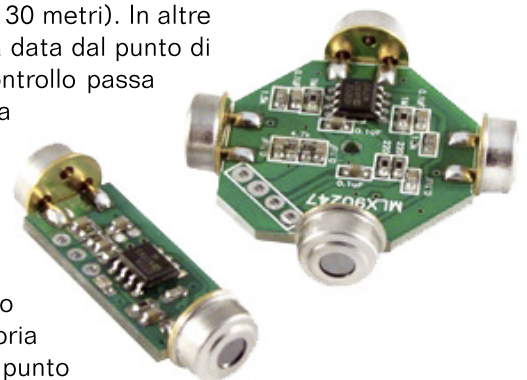
I due sensori XY e Z che consentono al modello di mantenere un assetto perfettamente stabilizzato.
